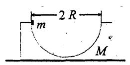
небольшую шайбу массы m так, что она располагается в вертикальной плоскости, проходящей через центр масс бруска, и отпускают ее без начального толчка. Пренебрегая трением, найти скорость шайбы относительно бруска в нижней точке ее траектории.
